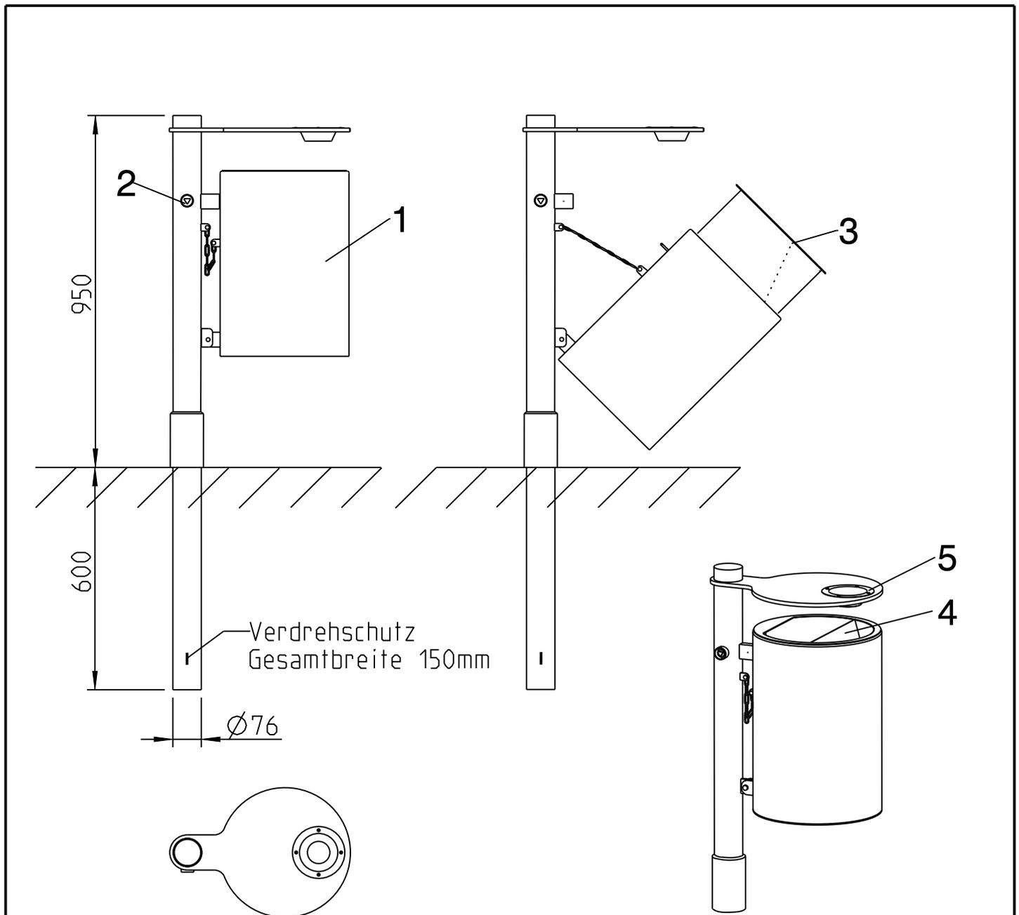
Standrohr des Abfallbehälters 0,6m in den Boden einlassen und einbetonieren.
