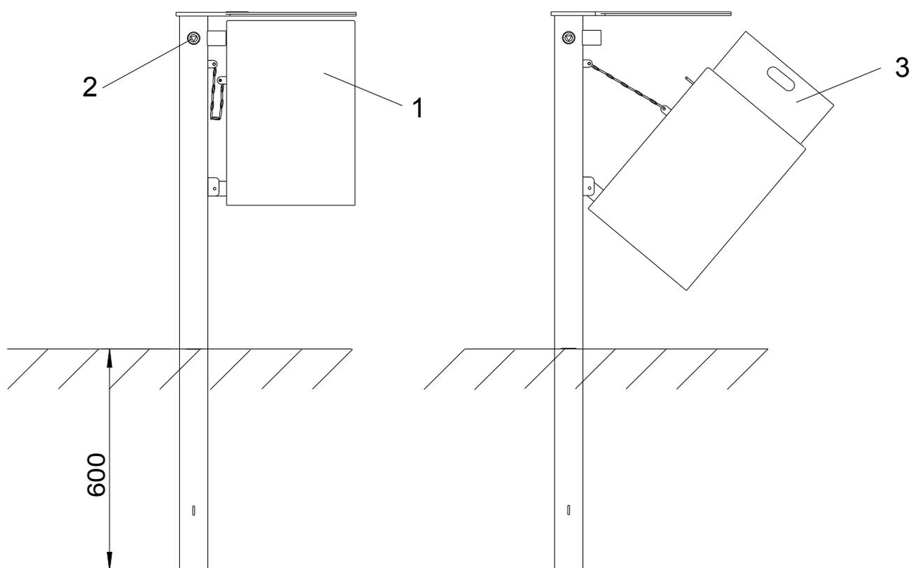
Standrohr des Abfallbehälters 0,6m in den Boden einlassen und einbetonieren.
