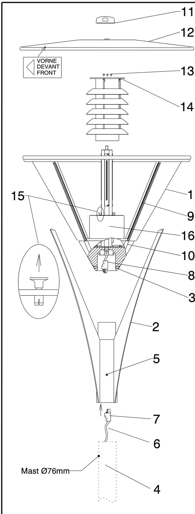
Leuchtenkopf (1) von Stele (2) mit Hilfe der 4 Gewindestifte M8 (3) lösen.
