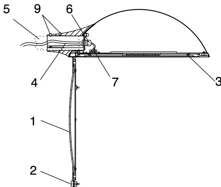
Die Abdeckung (1) öffnen. Dazu 3 Drehverschlüsse (2) mit einer Vierteldrehung dearrretieren und Abdeckung nach unten klappen.
