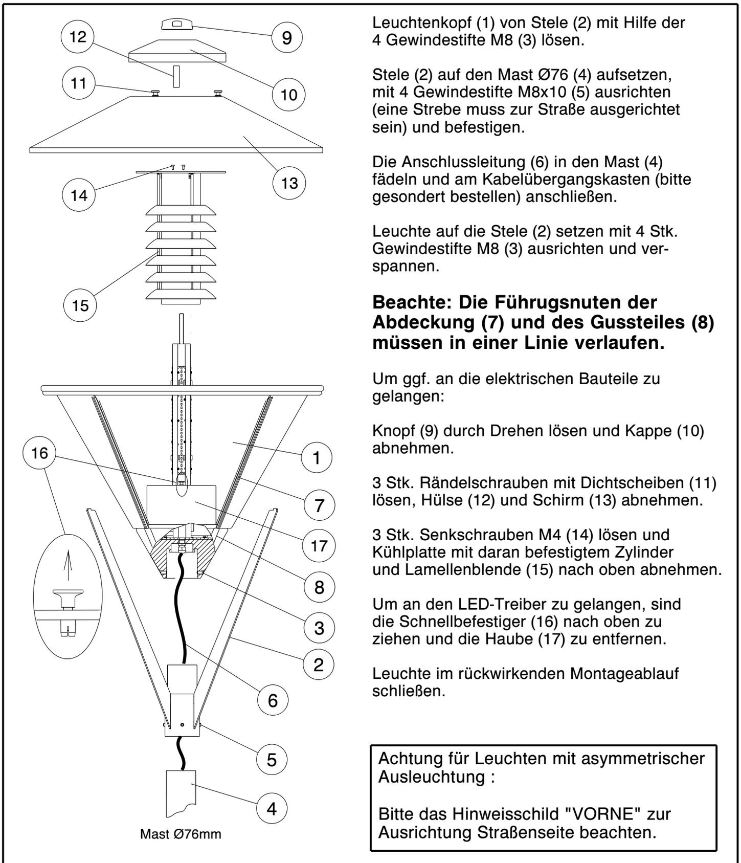
Leuchtenkopf (1) von Stele (2) mit Hilfe der 4 Gewindestifte M8 (3) lösen.
