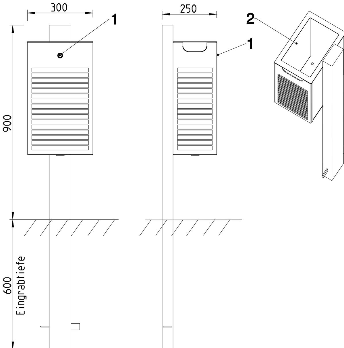
Den Abfallbehälter 0.6m in den Boden einlassen und einbetonieren.
