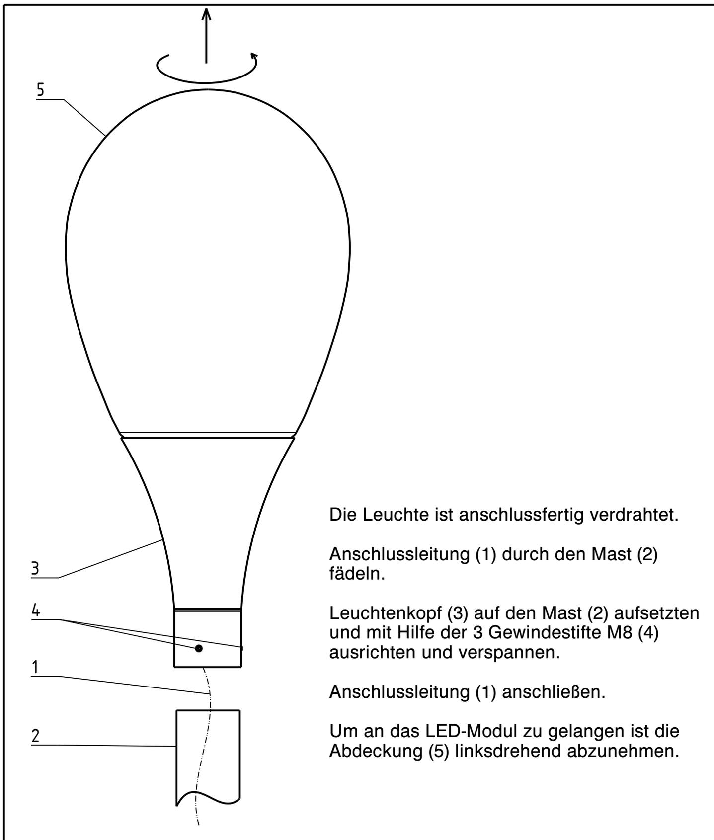
Die Leuchte ist anschlussfertig verdrahtet.
