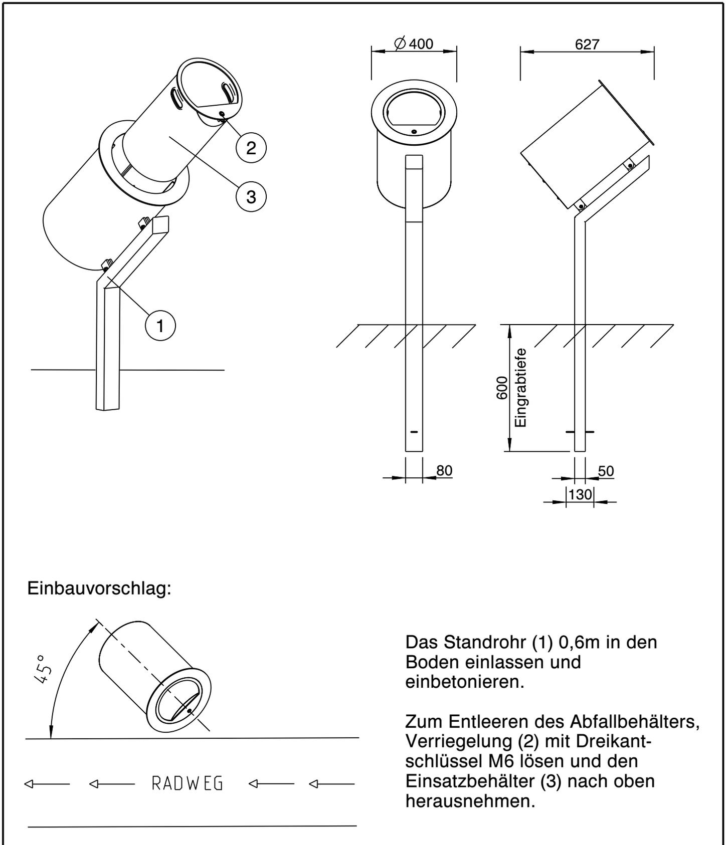
Das Standrohr (1) 0,6m in den Boden einlassen und einbetonieren.
