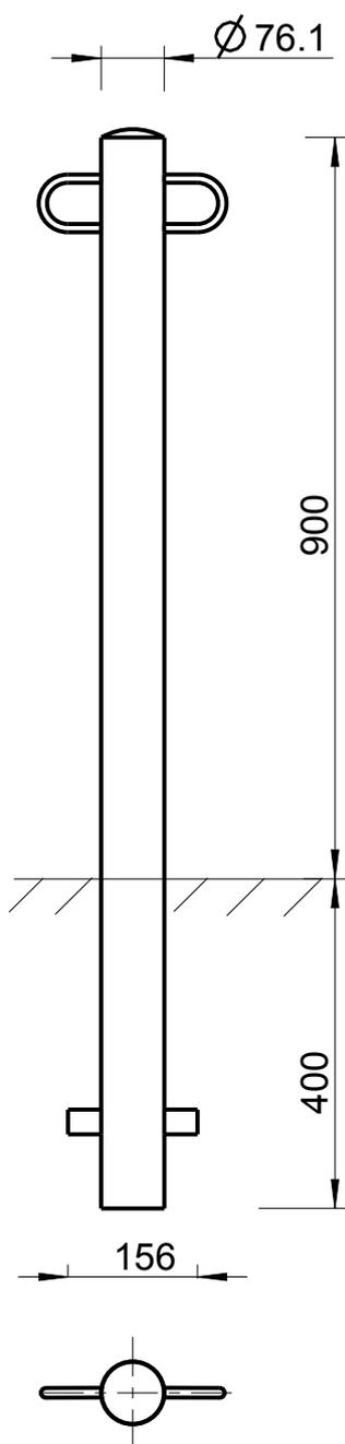
Absperrpoller 0,4m in den Boden einlassen und einbetonieren.
