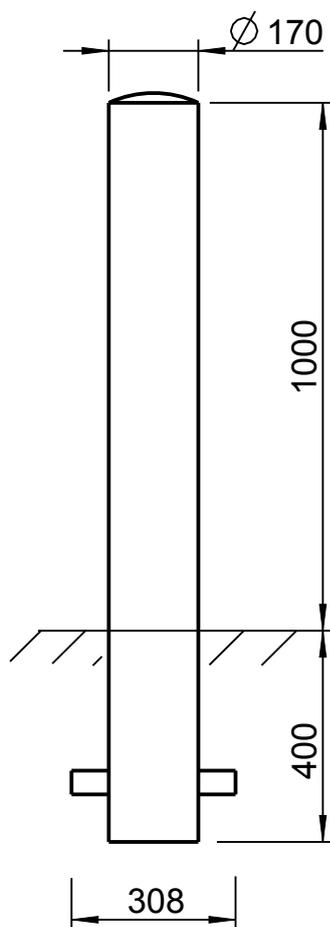
Absperrpoller 0,4m in den Boden einlassen und einbetonieren.
