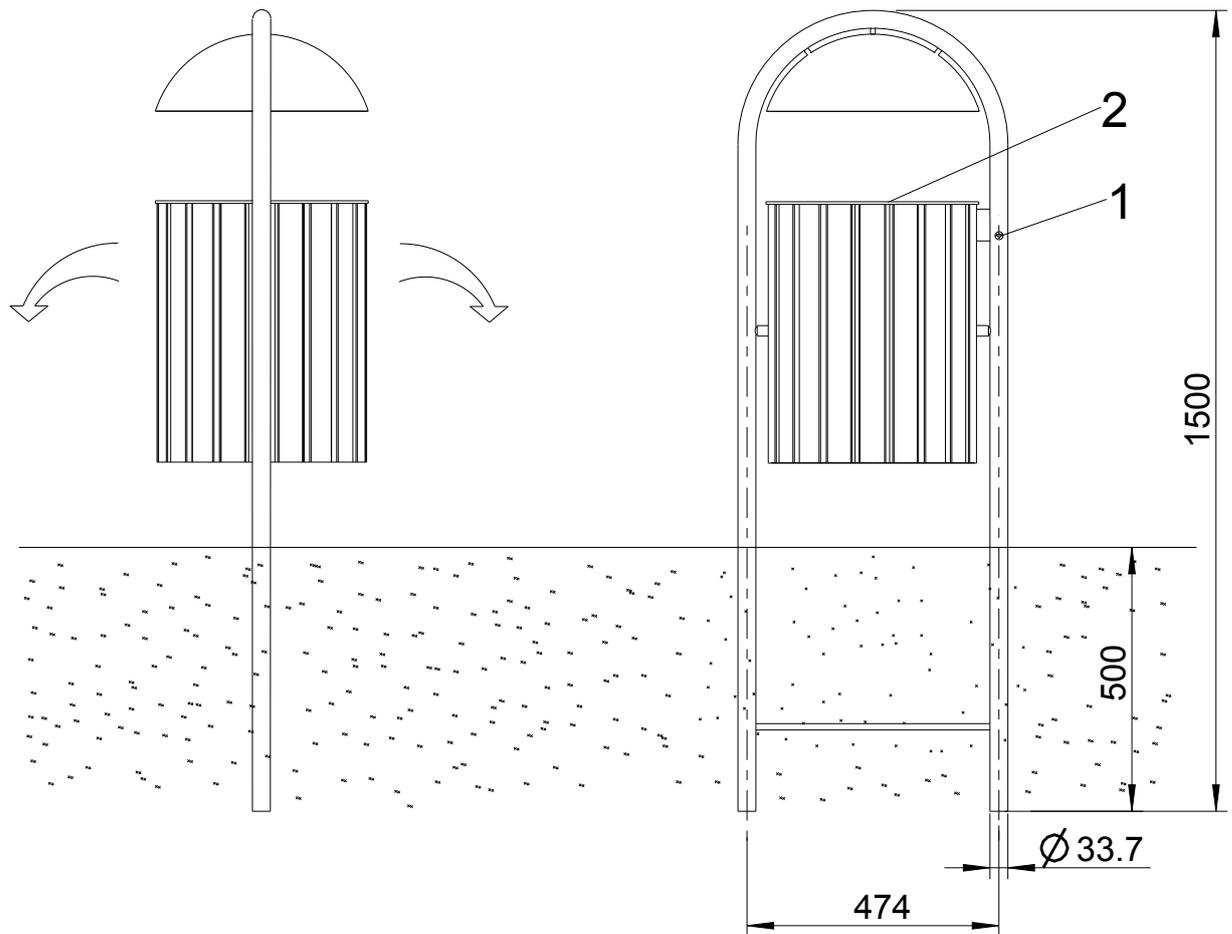
Abfallbehälter 0.5m in den Boden einlassen und einbetonieren.
