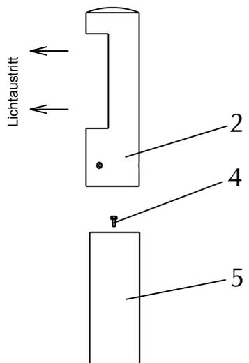
Durch Lösen der 3 Senkschrauben (1) Leuchtenkörper (2) vom Standrohr (3) nach oben abziehen.
