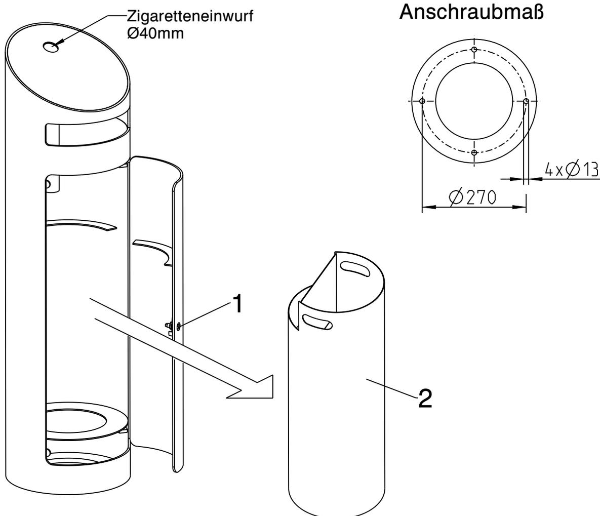
Abfallbehälter auf Betonfundament aufsetzen, Befestigungsbohrungen markieren und entsprechend den vorgesehenen Schrauben M10 bohren und am Fundament verschrauben.
